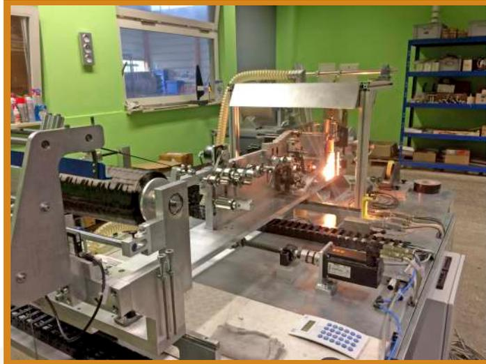
Im Wesentlichen handelt es sich dabei um einen Abwickler, einen Transport und einen Antrieb für den Aufwickler. Dazwischen findet dann ein Prozess statt. Oberste Priorität war zum modularen Hardware-/Maschinenaufbau einen ebenso modularen Softwareaufbau zu erstellen.
